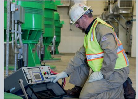
Motor- und Generatorprüfung
