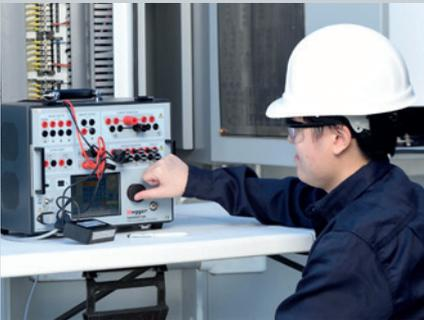
Ensayo del relé de protección
